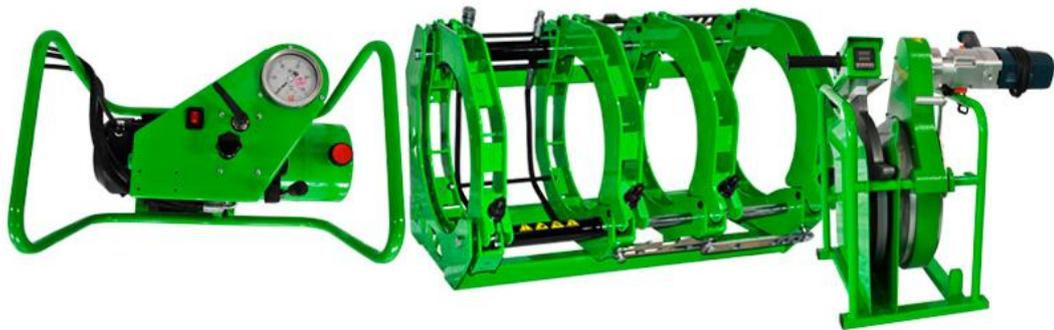
Центратор четырехзахимный - предназначен для центрирования и выравнивания торцов труб и соединительных деталей. Состоит из стальной рамы, пары подвижных хомутов, приводимых в движение гидравлическими цилиндрами и пары неподвижных хомутов. Диаметр свариваемых труб от 40 мм до 160 мм. *Габаритные размеры 790x390x350мм. Вес центратора 45 кг.*
