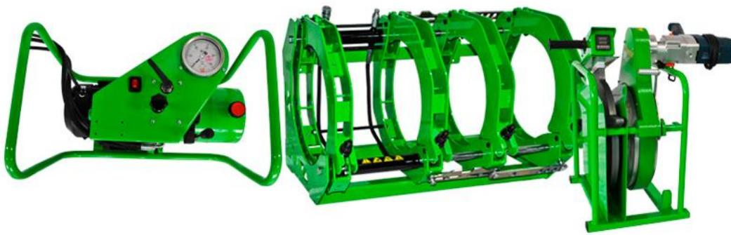
Центратор четырехзажимный - предназначен для центрирования и выравнивания торцов труб и соединительных деталей. Состоит из стальной рамы, пары подвижных хомутов, приводимых в движение гидравлическими цилиндрами и пары неподвижных хомутов. Диаметр свариваемых труб от 63 мм до 225 мм. Габаритные размеры 790x460x420мм. Вес центратора 55 кг.
