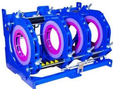
**Центратор**- предназначен для центрирования и выравнивания торцов труб и соединительных деталей. Состоит из стальной рамы, пары подвижных хомутов, приводимых в движение гидравлическими цилиндрами и пары неподвижных хомутов. Диаметр свариваемых труб от 710 мм до 1200 мм (в стандартную комплектацию входят диаметры 710, 800, 900, 1000 мм)
